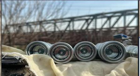
Niples con orificios calibrados.
