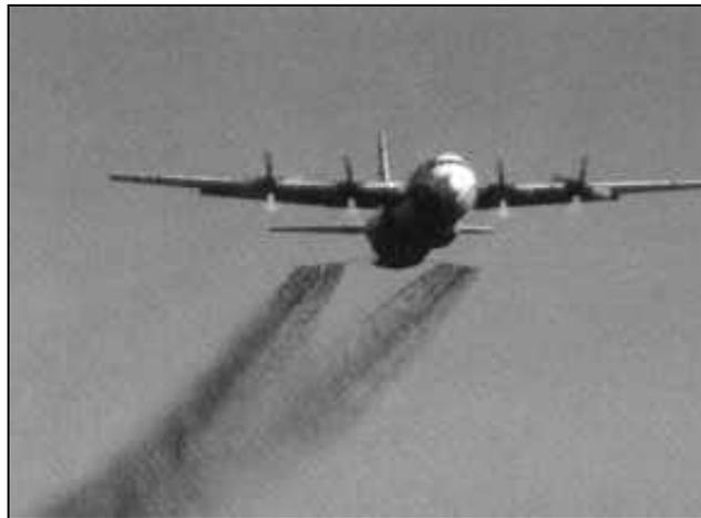
*Figura 10 - 5 Aplicación de dispersante por avión de ala fija*
