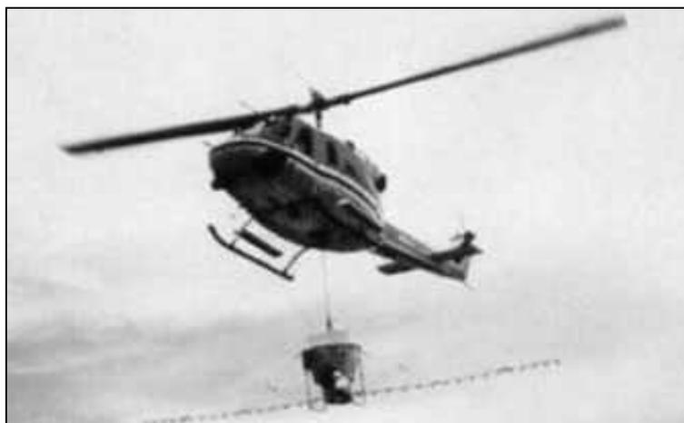
*Figura 10 - 6 Aplicación de dispersante por helicóptero*
