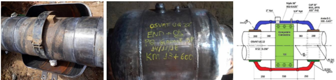
**Figura 7.7** Abrazadera doble tipo "Pumpkin", sobre Anillos, con Encapsulamiento Acoplado (con Collar de Refuerzo)
