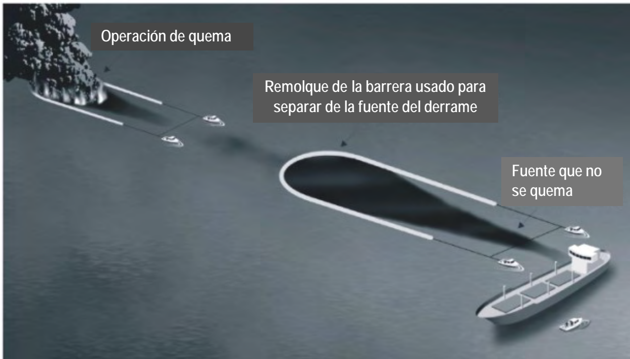
Figura 23 - Uso de la barrera remolcada para quemar y separar a la fuente del fuego
