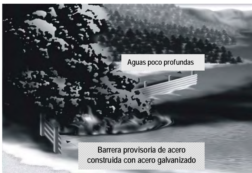
Figura 27 - Uso de barrera temporal de acero
