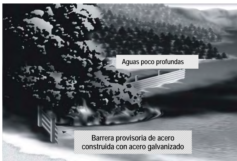
Figura C8: Uso de barrera temporal de acero
