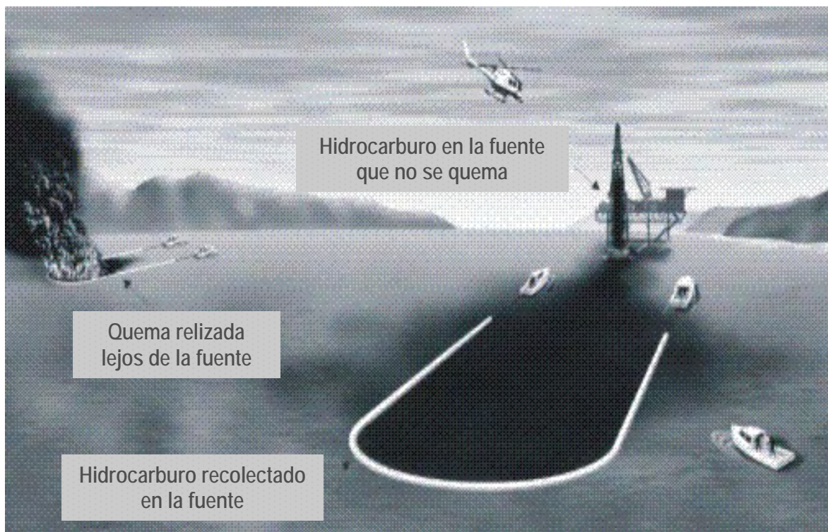
Figura C2: Uso de la barrera remolcada para juntar y quemar el hidrocarburo
