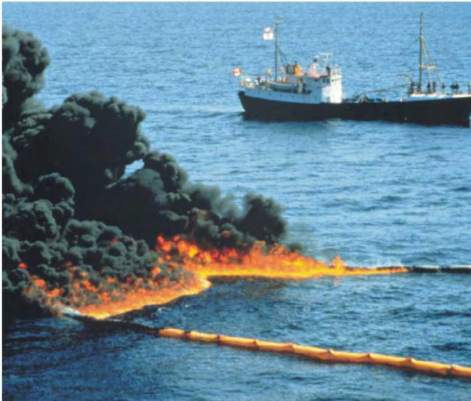
Figura 8: Quema de prueba en el mar Nótese que la barrera se remolcó en forma incorrecta en la dirección del viento y hay una pérdida debajo de la misma.
